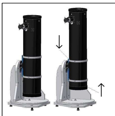
Figure B. Faites glisser la queue d'aronde du télescope et serrez fermement les deux boutons.
