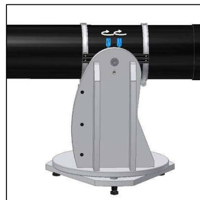
Figure C. Déplacez la queue d'aronde vers le bas et le tube vers le haut !
